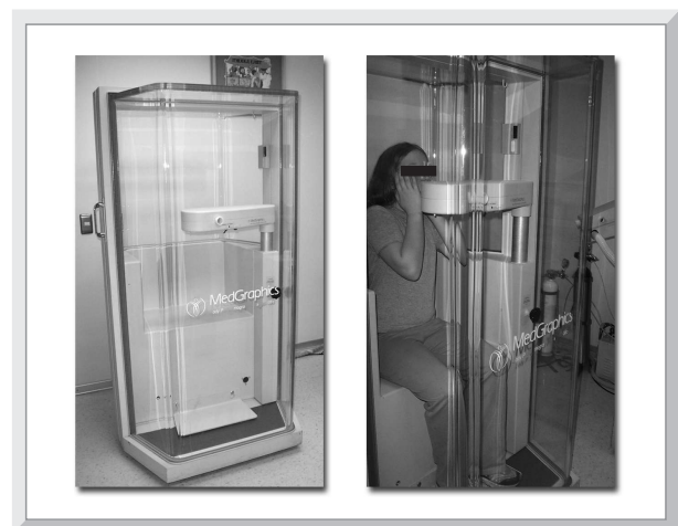
Figura 2.- Medición de volúmenes pulmonares en un niño escolar mediante pletismógrafo
